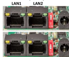
LAN2 порт размещен около переключателя и может быть включен в режим PoE Out для выдачи питания на сетевое устройство
